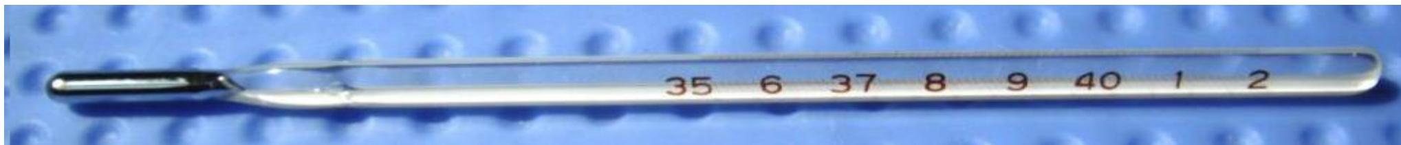
体温计用于测量人体温度。根据人体温度的变化情况，体温计的刻度范围通常为 $35\sim 42\text{ }^{\circ}\text{C}$ 。
