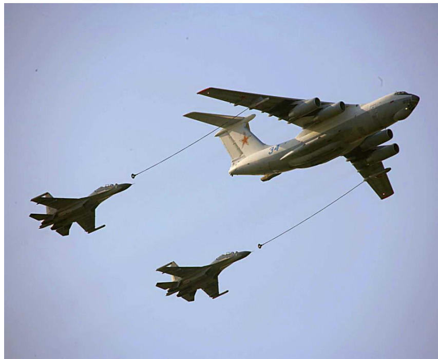
空中加油机正在加油
