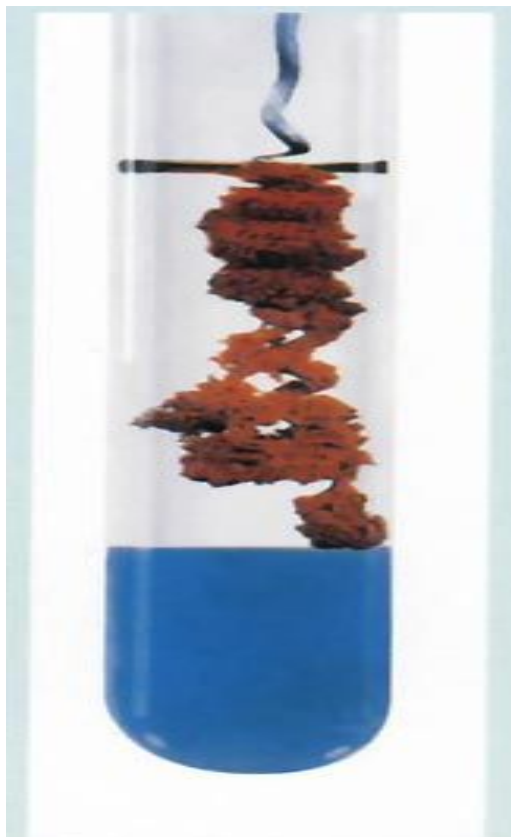
铝丝浸入 \text{CuSO}_4 溶液中 铝丝表面有红色固体出现
