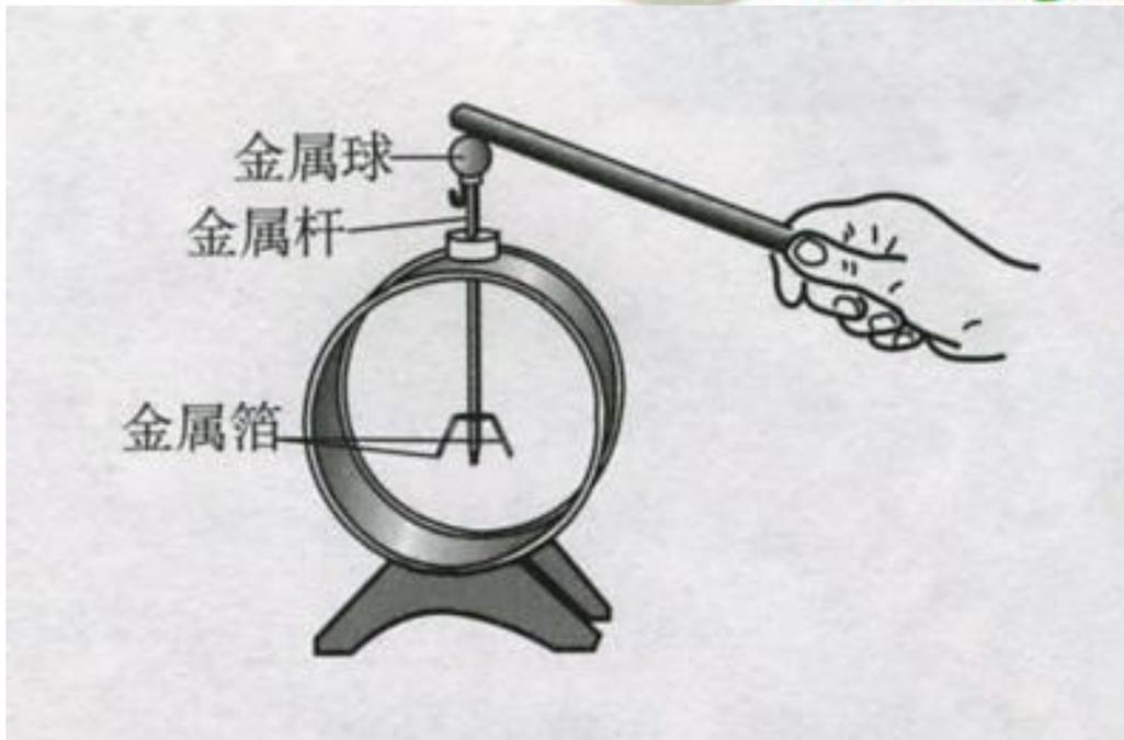
结 构：金属球、金属杆、金属箔
