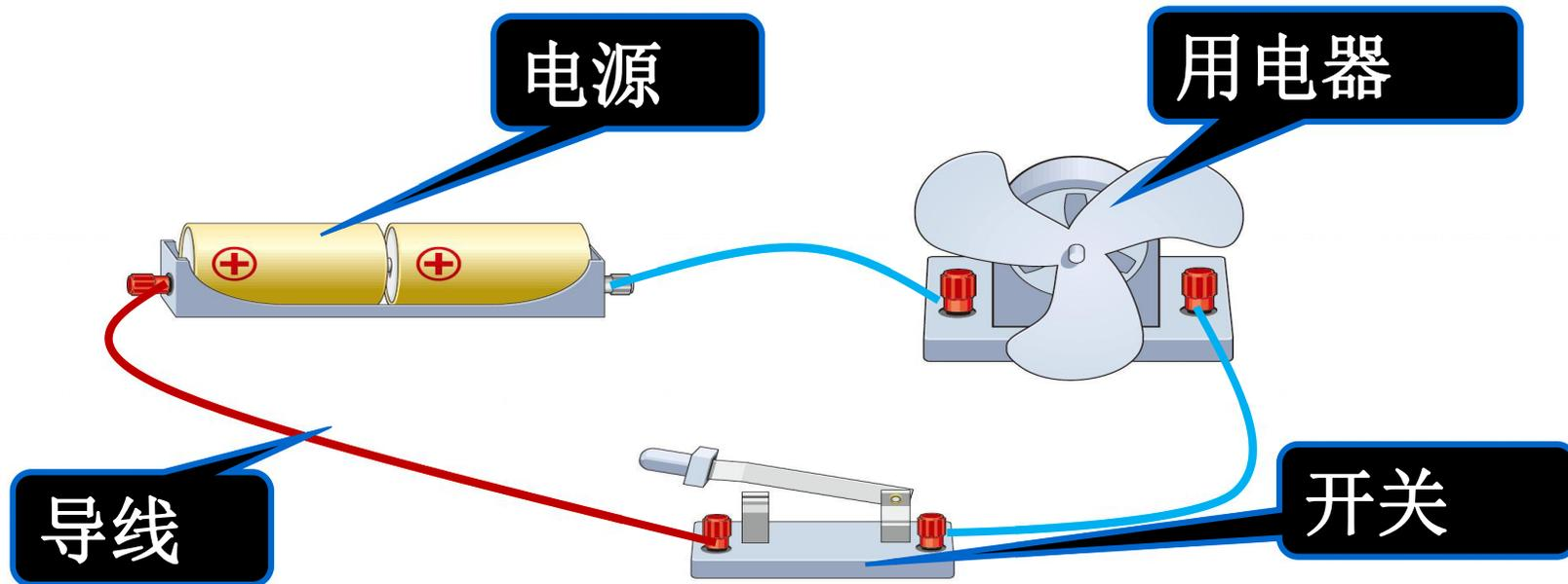
由电源、用电器、导线、开关组成的电流可以流过的路径叫做**电路**。
