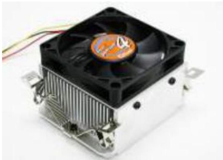
电脑中的CPU在工作时要产生热，如果过热就会损坏芯片，所以要在芯片上加装散热片和风扇。
